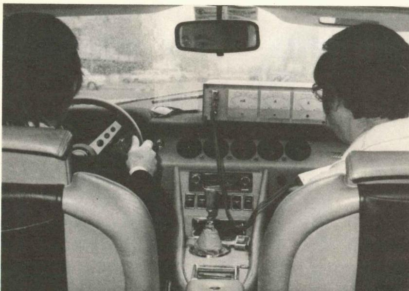
Ogni auto utilizzata nelle prove era dotata di una completa strumentazione per tenere sotto controllo ogni stadio dell'accensione. Un raid Milano-Roma a 230 km/h ha dimostrato ai piloti da corsa che tale accensione può fornire prestazioni veramente eccezionali.
